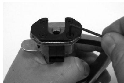
Фото 9. Откручивание плоских винтов при помощи шестигранника.
