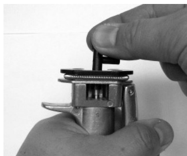
Фото 2. Удаление и установка толкателя.
